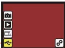
Dopo aver finito la memorizzazione, l'utente può scaricare le immagini memorizzate dalla memoria interna o la scheda SD nel PC selezionando la modalità USB. Premere il pulsante OK quando si connette il cavo USB al PC, **Rollei DF-S100 SE** diventa un dispositivo di archiviazione di massa. L'utente può rivedere o modificare le immagini una volta anche il PC ha rilevato il dispositivo di archiviazione di massa. O estrarre la scheda SD dal dispositivo nel PC per leggere le immagini direttamente.
