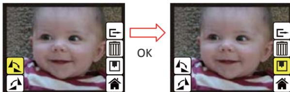
Se l'utente vuole rotare di +90 gradi, è possibile premere il pulsante OK, l'immagine ruota di +90 gradi e il cursore rimarrà in salvataggio. Premere il pulsante OK di nuovo per salvare il risultato modificato e l'immagine successiva verrà mostrata (N+1). Per utilizzare Ruotare +90 gradi con frequenza, spostare il cursore di nuovo su Ruota e premere OK. (Stesso per Ruota -90, Specchio e funzione Capovolgì)
